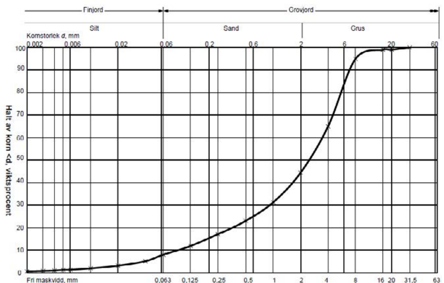
Figur 16. Kornfördelning och fraktionsindelning av stenmjöl (sandigt, lerigt GRUS) med hög halt av calcium, källa SGI.
