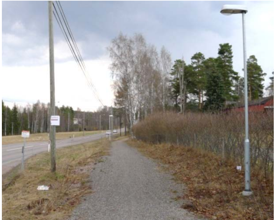
Figur 9. Exempel på sommarcykelväg med "grövre" grus (förmodligen 0-16 mm) som upplevs svår att cykla på.
