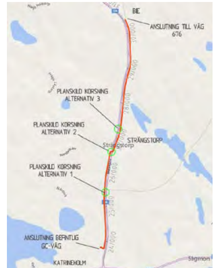
Figur 6. Föreslagen sträckning och placering av planskild passage (källa PM Ny gång- och cykelväg Väg 56, Katrineholm-Bie).
