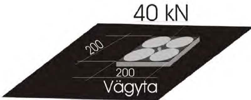
Figur 8. Prov med last, 40 kN (källa TRVR Väg)
