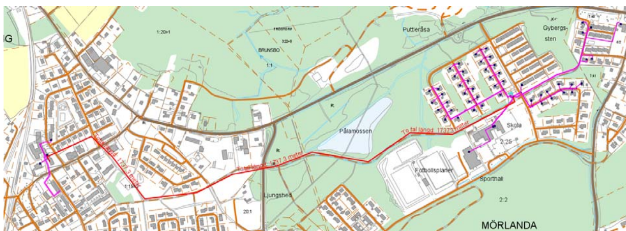
Figur 6.1. Föreslagen ledningssträckning för fjärrvärme PC Mörlanda till PC Gäsenegården.
