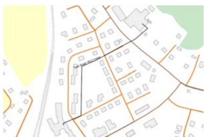
Figur 7.1. Föreslagen ledningssträckning för fjärrvärme Gäsene Mejeri till PC Gäsenegården.
