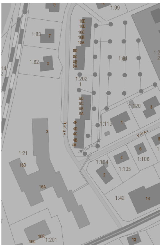
Figur 3.1. Skiss över föreslagen energiborrhålsplacering.
